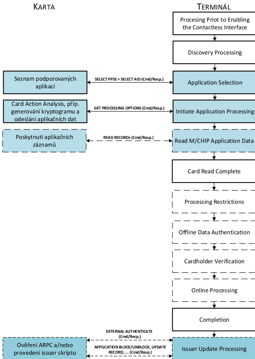
Obr. 6: Příklad flow PayWave transakce v režimu qVSDC
