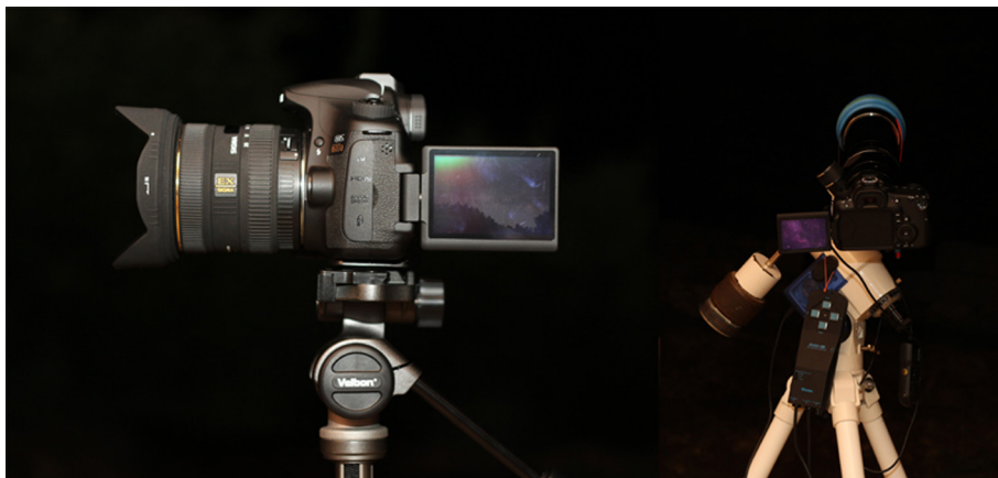
Obr. 1: Různé varianty stativu pro pořizování snímků – fixní stativ (vlevo) a paralaktická montáž německého typu (Vixen GP2 Photoguider, vpravo)
