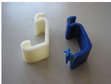
Obr. 6: Atypická součástka v Blenderu Obr. 7: Nový díl a rozkousaný originál
